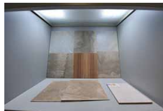
FIG. 3 e 4 - Cabina multiluce Colouroom 20 vista dall'interno: si può notare il confronto immediato e semplice tra prodotti di diverse tonalità, realizzati su diversi materiali
